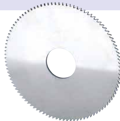
zub jemně vybrošovaný tvar A pod úhlem DIN 1840 (úhel čela bříty 5°)
